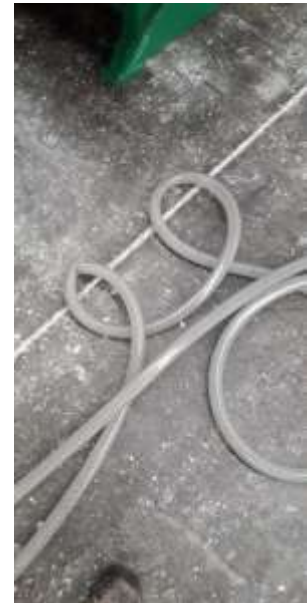
Ilustración 14 manguera doblada y obstruida
