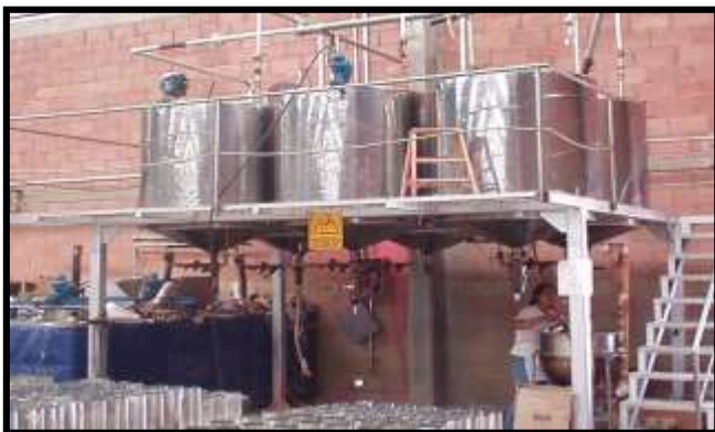
Ilustración 31 depósitos de parafina
