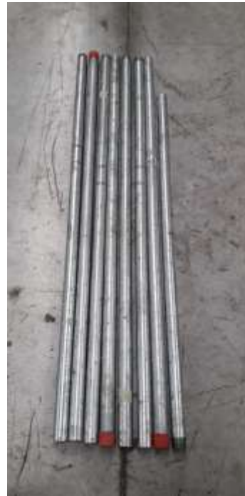
Ilustración 30 tubería que se utilizará que es galvanizada
